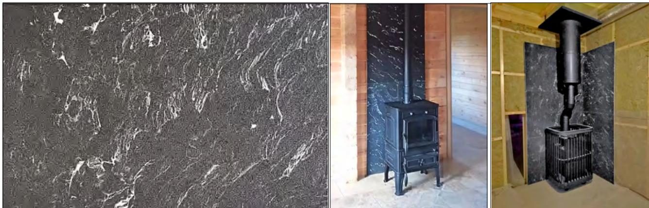
Защитный экран выполнен из микрокальцита (мраморная крошка) на основе фиброцементной плиты. Фиброцемент – ударопрочная, негорючая, цементно-волоконистая экологически чистая плита. Частицы микрокальцита связаны между собой с помощью акрилатов. Размер 1200x800x12мм. Вес 12 кг.
